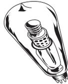
A la hora de sustituir la válvulas de salida, observe la marcación de válvulas específica del proveedor de las válvulas originales de su amplificador. Por ejemplo, los tipos de válvula de salida 6L6 usados por Fender incluyen, pero sin limitación alguna: 6L6GC; 6L6WXT; 6L6GE; etc. La instalación de una válvula de otro tipo diferente puede requerir un ajuste complejo realizado por un
