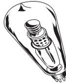
さらに、Fender Groove Tubesでは、沢山の出力真空管をテストし、実測性能に基づいて分類しています。分類された真空管は、1-10まで細密にレーティングされ、大きな区分としてブルー、ホワイト、レッドにレーティングされ、大きな区分としてブルー、ホワイト、レッドにレーティングされます。オリジナルの真空管を交換いただく際には、マッチングしたペアの、同じレーティング（できればブルー、ホワイト、レッドのラベルも一致したもの）の出力真空管をご使用いただくのが理想的です。ただし、ファイン・レーティングの番号が、オリジナルと1番違い以内の場合は、アンプのバイアスの再設定をしなくても、ご使用いただくことができます。
