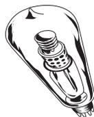
Achten Sie beim Ersetzen von Ausgangsröhren bitte auf die speziellen Röhrenmarkierungen auf den Originalröhren, die ab Werk mit dem Amp geliefert werden. Beispiel: Zu den von Fender benutzten 6L6 Ausgangsröhrentypen gehören unter anderen: 6L6GC, 6L6WXT, 6L6GE etc. Die Installation eines anderen Typs erfordert möglicherweise beträchtliche Einstellungen durch einen qualifizierten
